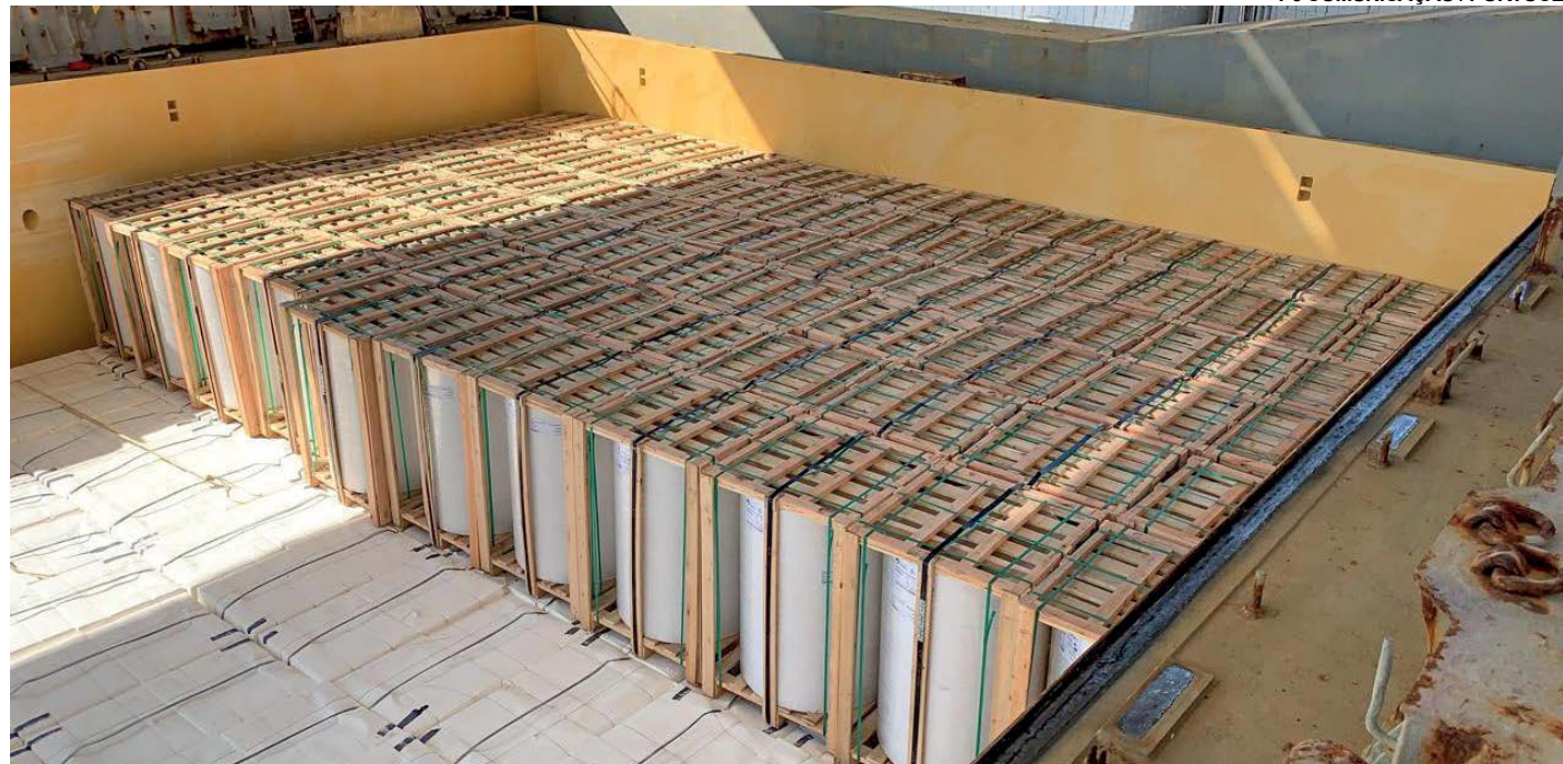
BOBINAS alocadas no porão do navio
